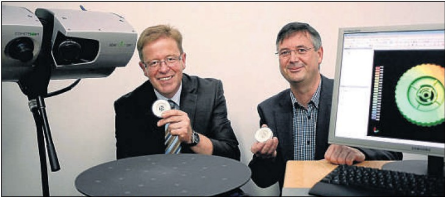
Messtechnik: Diplom-Ingenieur Andreas Rühmer (rechts) und Bürgermeister Heinfried Horsel halten Kunststoff-Verschlüsse eines Luftbefeuchters in den Händen. Das Mess-System mit Weißlichtstreifen-Projektion (links) hat daraus ein Computerbild erzeugt, das kleinste Abweichungen feststellt und auch farblich darstellen kann (auf dem Monitor rechts).
